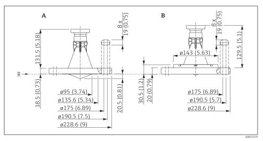
🗷 25 FMR50 mit slip-on flange 4"/DN100; dimensions: mm (in)
